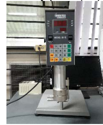
Máquina para pruebas de tensión Com-Ten (capacidad 10 kg/90 kg.)
