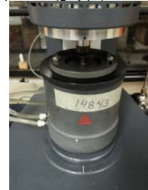
Cilindros concéntricos de doble pared (gap) (Peltier)
